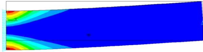
Zredukowane odkształcenia plastyczne (100% obciążenia)
